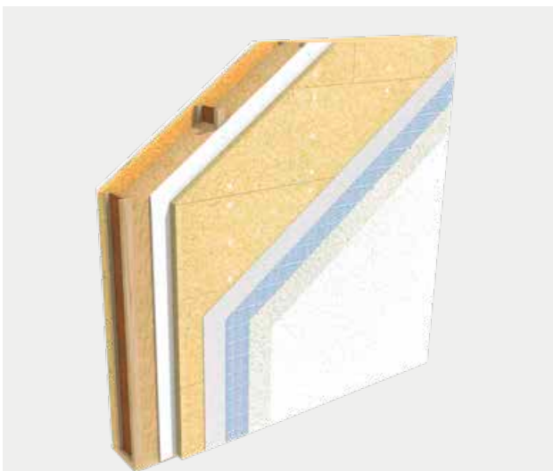
Holzrahmenkonstruktionen mit Plattenwerkstoff außen
